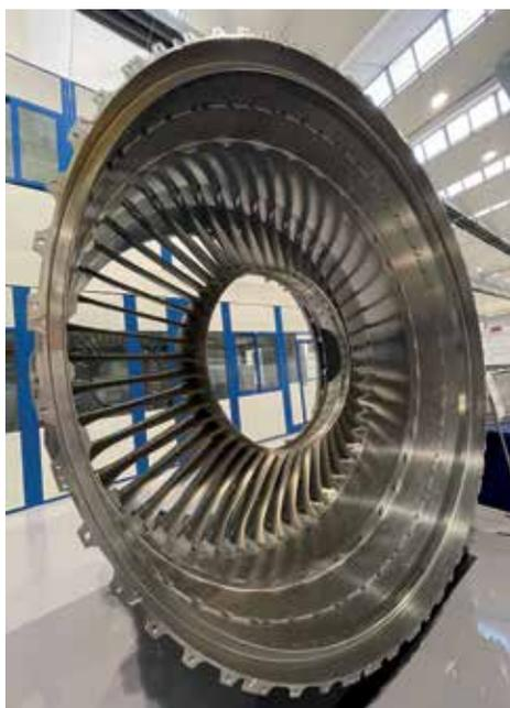
A sinistra: i componenti lavorati da Fly per l'aerospace hanno dai 400 ai 4.000 mm di diametro e sono realizzati in leghe leggere, leghe metalliche superleghe
