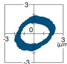
La maggior parte dei problemi associati alle microlavorazioni è causata da un'insufficiente precisione di concentricità del mandrino macchina. Abbiamo creato un sistema di misurazione del runout in grado di rilevare il movimento del mandrino durante la rotazione ad alta velocità e di ottenere la migliore precisione di runout dinamico.
