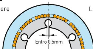
La sezione del mandrino Hi-Power Milling Chuck presenta fori e fessure combinate a intervalli regolari per soddisfare entrambi i requisiti.
