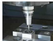
Incredibile precisione di concentricità entro 1µm a 4xD. Il mandrino idraulico con le migliori prestazioni di precisione.
