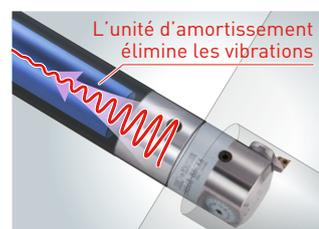
Un amortisseur exclusif intégré, qui fonctionne aussi bien comme amortisseur à force de réaction que comme amortisseur à friction. Le contrepois, dont le brevet a été déposé, maximise l'effet de l'amortisseur à friction. Les vibrations sont amorties efficacement et la précision d'usinage est accrue.
