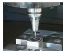
Une concentricité impressionnante comprise dans 1 µm à 4xD. Le mandrin hydraulique de haute précision par excellence
