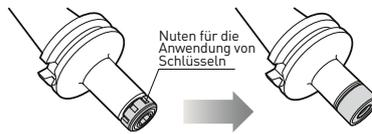
**Das nutenfreie Design der MEGA NUT Spannmutter verhindert Vibrationen und reduziert Geräusche.**
