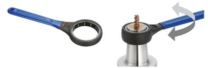
**Einfach und sicher Spannen mit dem MEGA-Rollenschlüssel**
