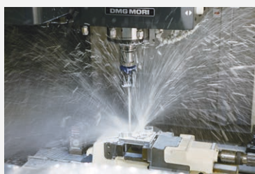
Schritt-1: Hochdruckreinigung mit IK durchs Zentrum in der Mitte
