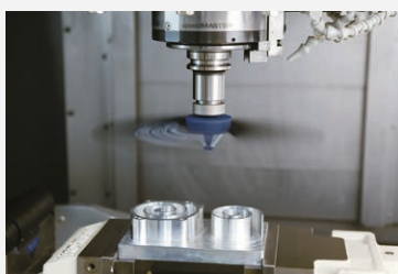
Schritt-2: Durch die Spindel-Rotation wird ein hoher Luftstrom erzeugt mit dem Werkstücke und Vorrichtungen optimal gereinigt werden.
