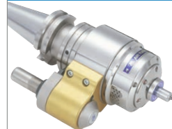
Turbine à Air
