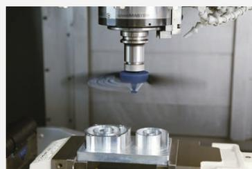
**Schritt-2:** Durch die Spindel-Rotation wird ein hoher Luftstrom erzeugt mit dem Werkstücke und Vorrichtungen optimal gereinigt werden.
