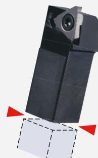
Bitte bereiten Sie einen Vierkanthalter von 16 mm vor und schneiden Sie es so zu, dass der Halter so wenig wie möglich herausragt.
